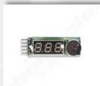
kann man die Lipos vor dem Einsatz testen. Der LiPo -Tester wird auf den Balanceranschluss des Akkus gesteckt und zeigt uns an, ob alle Zellen voll sind. Es gibt solche Tester auch mit akustischem Signalgeber. Diesen Tester lässt man am Balanceranschluss während des Spielens stecken. Ist eine Zelle am Limit, dann piepst der Tester.
