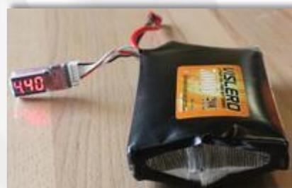
Der LiPo-Tester zeigt eine Spannung von 4,4V pro Zelle - Maximal zulässig ist 4,22V
