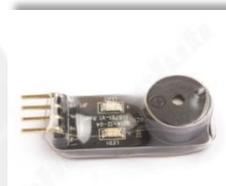
Mit einem schrillen Piepton signalisiert er die Überstrapazierung oder sogar das der Akku generell geladen werden sollte.
